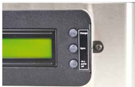
NoteSync 2 kann optional mit einer LCD-Anzeige ausgestattet werden, z.B. im Deckel einer NoteCase oder an der Tür einer NoteBox.
